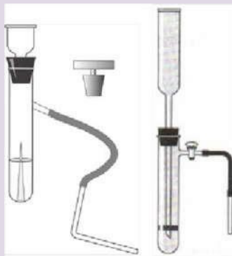
Рис. 7. Прибор для получения и собирания газов
